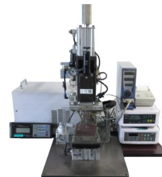
スポット溶接 Spot welder SEIWA
